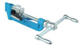
Fuerte y de fácil manejo, con acabado resistente a la corrosión. Posee un rulemán entre la manija y el cuerpo de la herramienta, cuya función, es reducir la fricción entre ambas cuando se tensiona el fleje.
